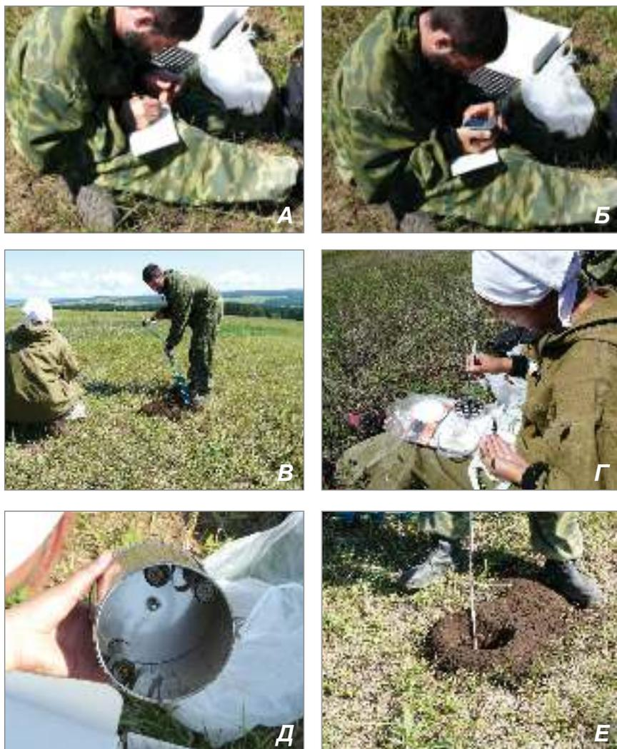
Рис. 21. Установка ПК в грунт: А — запись номеров концентраторов; Б — определение координат по GPS-навигатору; В — бурение шурфа; Г — замена герметичных вкладышей на фильтры; Д — установка контейнеров в банку; Е — установка банки в шурф [Создание эффективной..., 2008ф]
