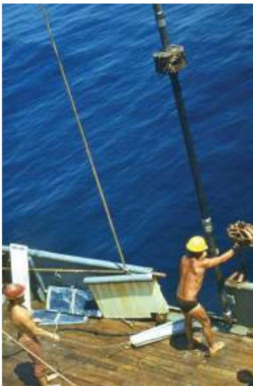
Рис. 12. Подъем грунтовой трубки на Черном море
