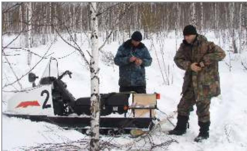
Рис. 38. Отбор пробы снега в стеклянную банку с ПК
