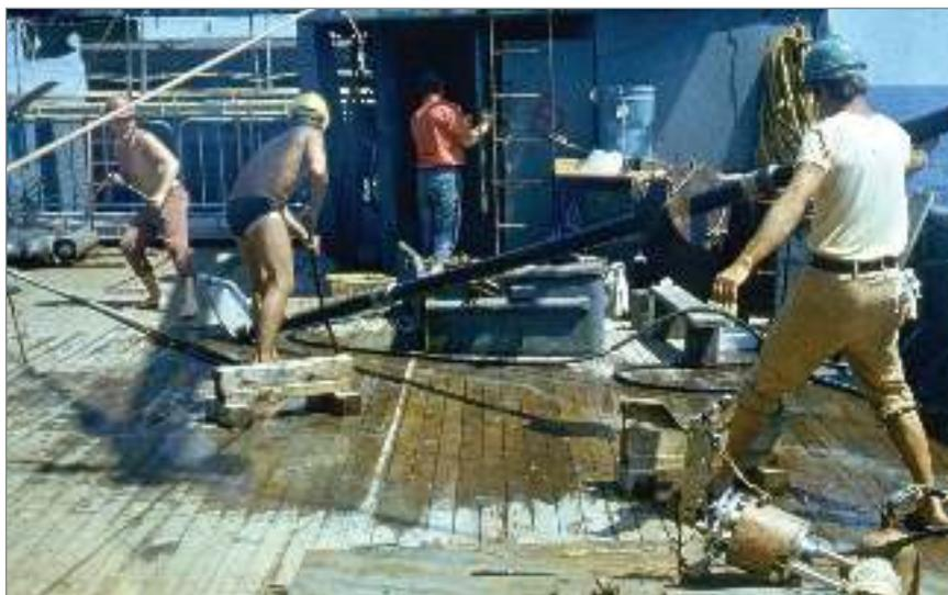
Рис. 13. Укладка грунтовой трубки на палубе после подъема
