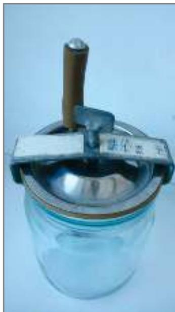
Рис. 27. Стекло́нная банка с герметичной крышкой для отбора проб снега
