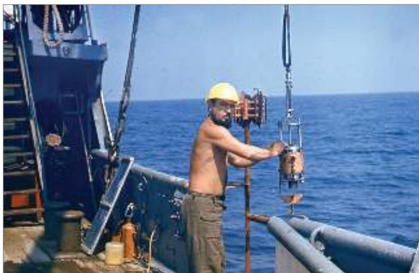
Рис. 16. Спуск батометра для отбора придонных вод
