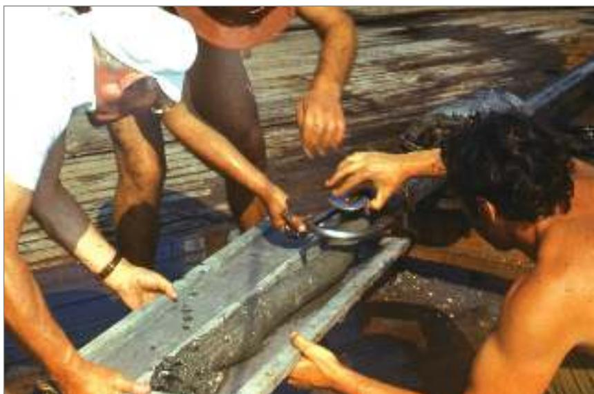
Рис. 14. Отбор донных осадков из грунтовой трубки
