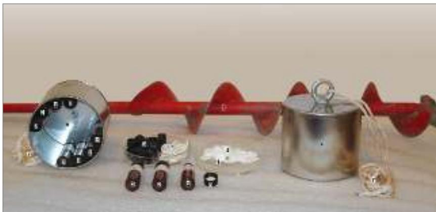
Рис. 19. Оборудование для установки ПК: 1 — концентратор; 2 — контейнер для переноски и хранения концентраторов; 3 — крышка контейнера; 4 — тефлоновый пористый фильтр; 5 — кольца для уплотнения фильтра; 6 — пробоотборная банка; 7 — капроновый шнур; 8 — шнек ручного бура [Создание эффективной..., 2008ф]
